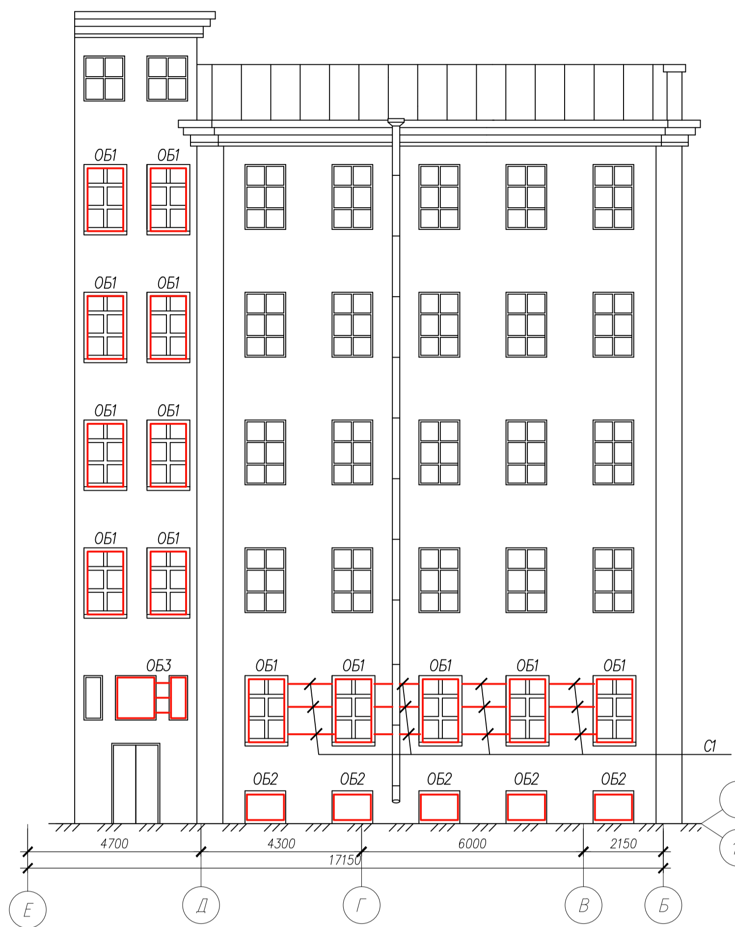
Фасад в осях "9-10/Е-Б"
